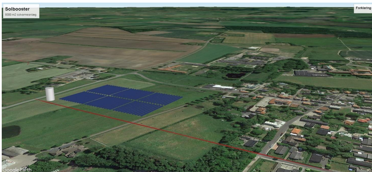
Figur 4.3: 3d skitse af et solboosteranlæg på ca. 8000 m 2 og 2000 m 3 akkumuleringskøle, som modelleres for driftssituation 3 og 4
