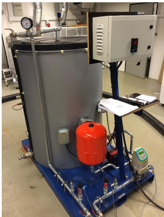
Figur 4-1 Fjernvarme: Varmekilde i laboratoriet er baseret på el, beholdertemperaturen reguleres med PID-regulator, pumpe kan stilles til konstant tryk, flowmåler til primærsiden er placeret ved varmekilde, der er desuden placeret tryk- og temperaturfølere ved varmekilden.
