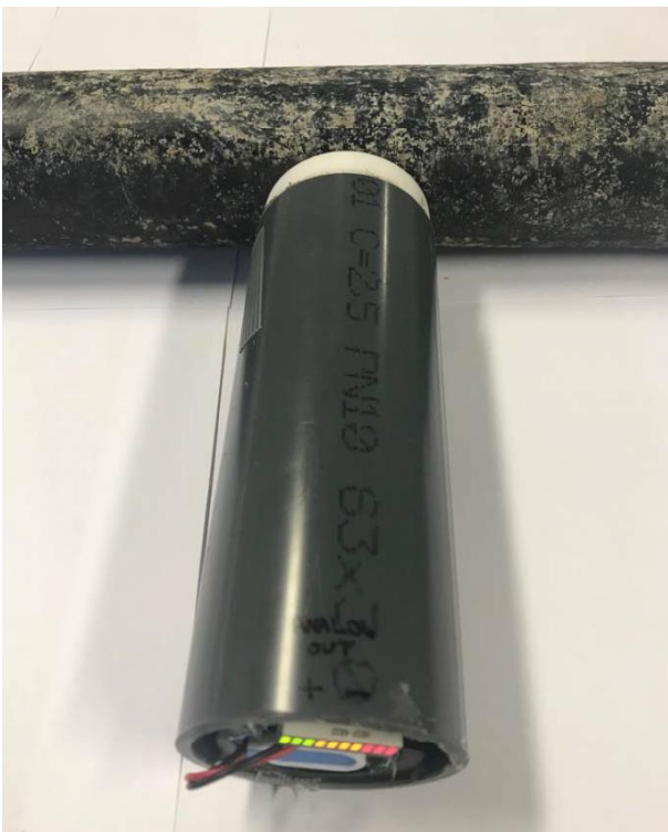
Figur 4: Apparatet (forrest) anvendes her til måling på et meget fugtig rørstykke (bagerst). Bemærk udslaget på LED-displayet og sammenlign med figur 5–8.
