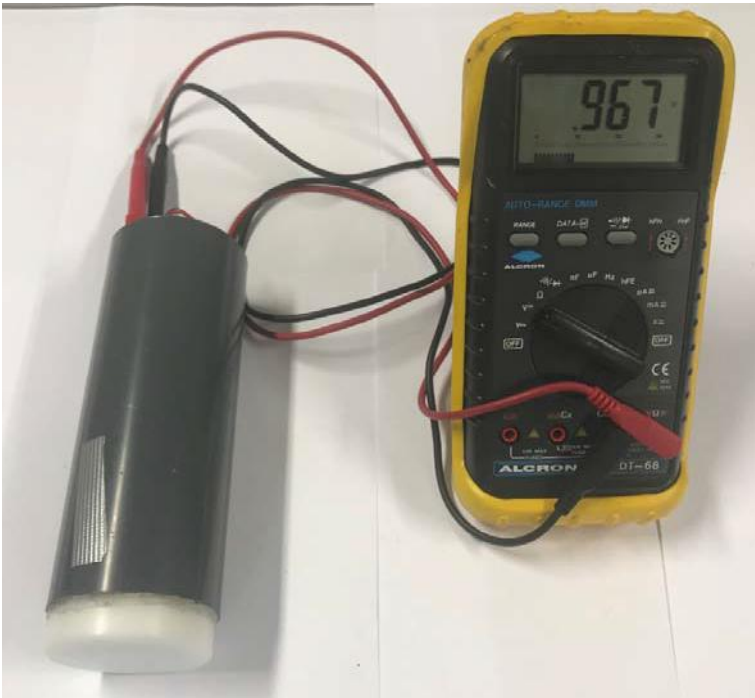
Figur 3: Måleapparatet (t.v.) – den hvide mikrobølgesensor ses forrest. Bagest (se figur 4–8) er LED-displayet placeret. (Voltmeteret til højre er kun tilsluttet for at udføre en indledende kontrol og er ikke nødvendigt i daglig brug.)
