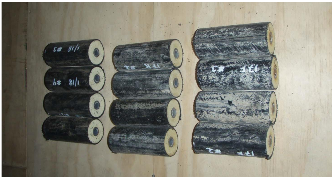
Figur 2: Udsavede rørstykker á 15 cm længde lagt til udtørring ved 70 °C indtil vægten var konstant
