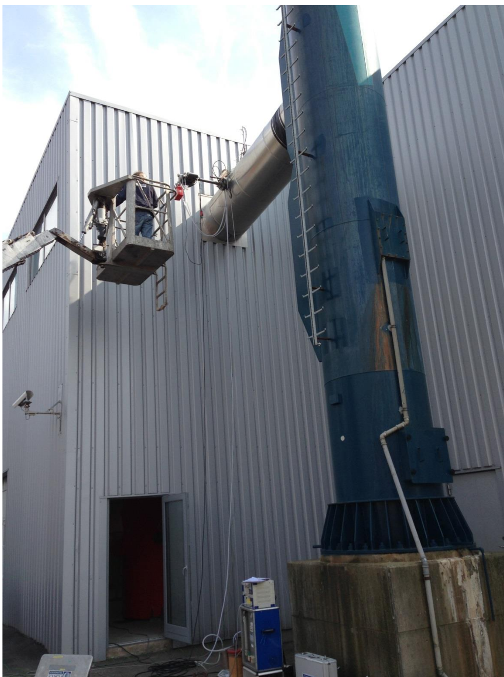
Figur 9. FORCEs testudstyr til måling af røggassen
