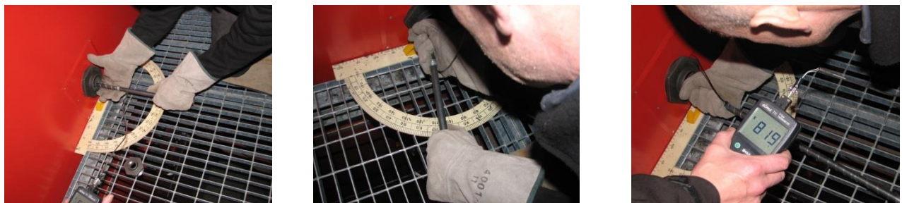
Figur 5. Måling af temperaturen i Høng Varmeværks halmkedel.
