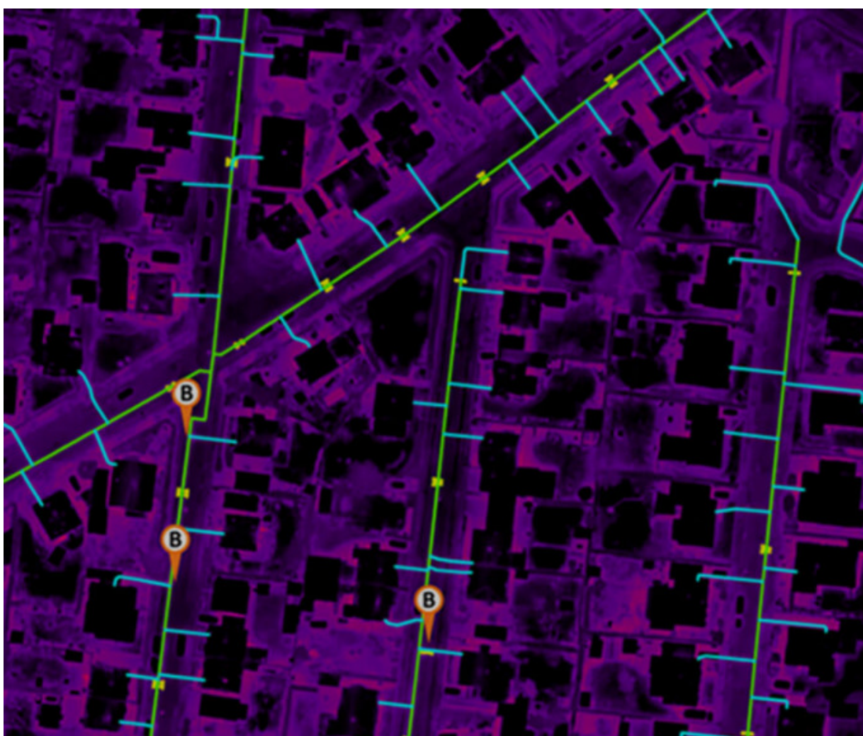
Figur 1: Eksempel på visning med termografi-mosaik som baggrund, ledningsregistrering og "B"-karakter-anmærkninger.
