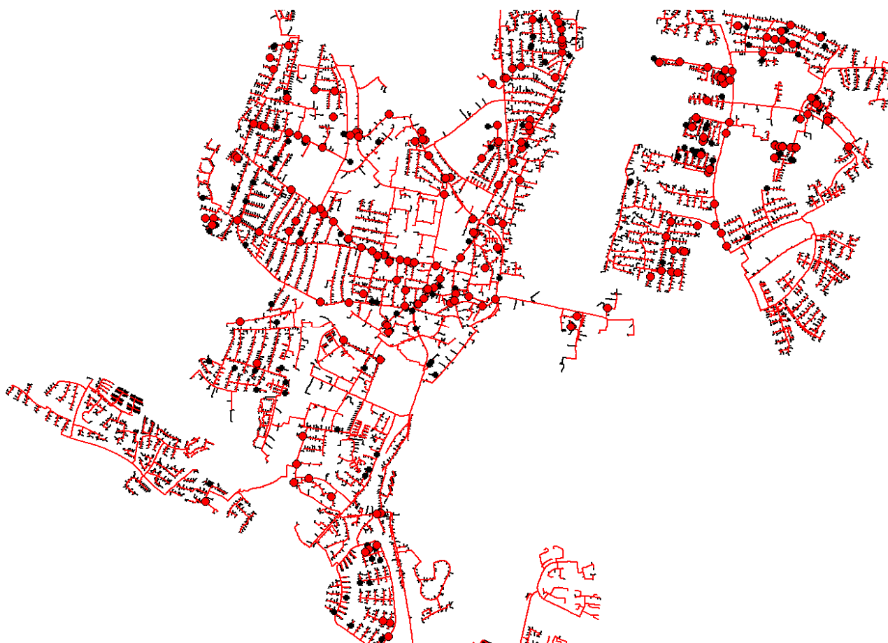
Figur 2: Hovedledninger med rødt, stik med sort, brud på hovedledninger med røde cirkler, brud på stik med sorte cirkler.
