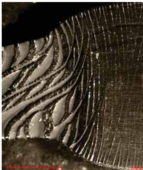
Figur 3. Foto af strækzone med revnet overflade
