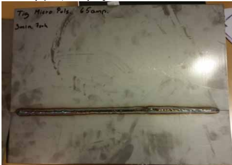
Figur 6: Svejseprøvning med TIG-svejsning (Micro Puls, 65 amp.)
