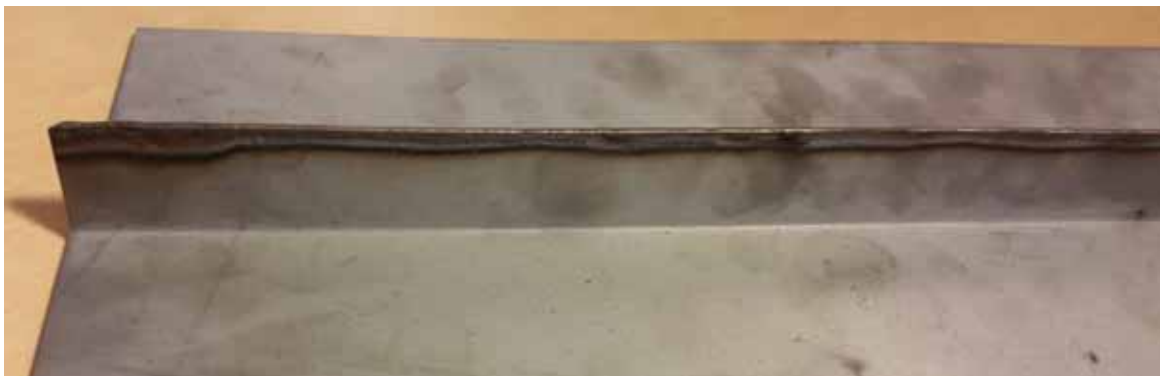
Figur 8: TIG-svejsning (TIG-puls) med dobbelt opbuk. Svejsetid ca. 75 sek./meter. Lang ophæftelestid.
