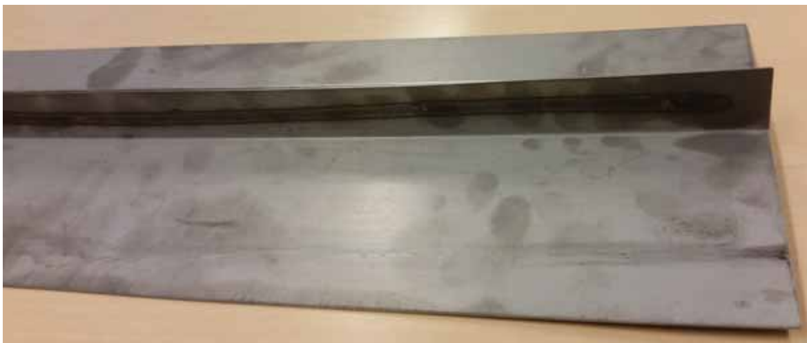
Figur 11: Stålliner svejset med en induktionssvejsning med pulsdraft. Svejsetid ca. 52 sek./meter. Skal ikke hæftes.
