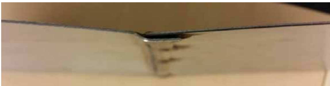
Figur 7: TIG-svejsning af stålliner, hvor der på den ene stål er bukket en fals.
