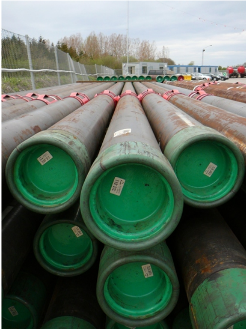
Figur 17: 9 5/8" casing med centralisers.
