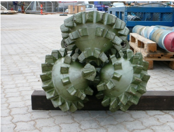
Figur 15: 24" borekrone af typen 'roller cone'.
