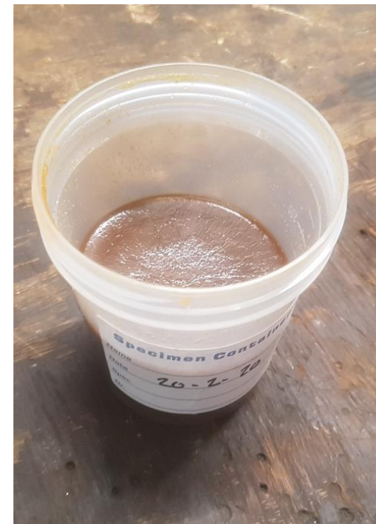
Batch med fiskeolie som er størknet ved stuetemperatur.
