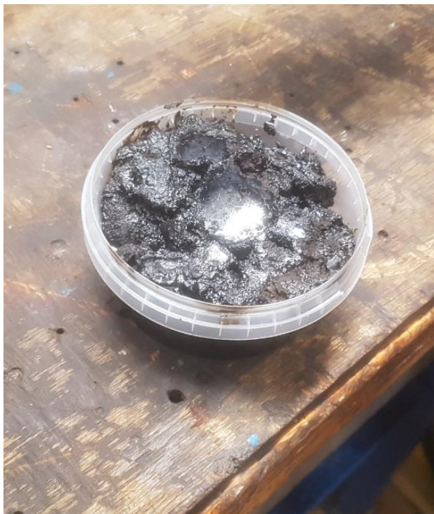
Resterne af en batch med vegetabilsk olie i form af soja og raps som har efterladt slam/bundfald i bioolie tanken.
