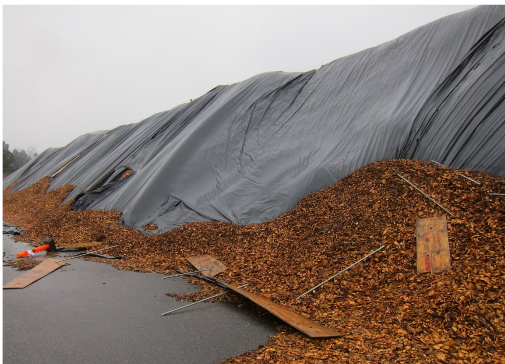
Billede 4: Presenningen holdes nede med en kant af flis. Desuden holdes presenningen fast med jernstænger og finérplader. Som det ses på billedet, så er stænger og plader blæst af og presenningen delvist gået i stykker. Ud over indkøb og oplægning, så er det et arbejde at vedligeholde og bortskaffe presenningen.
