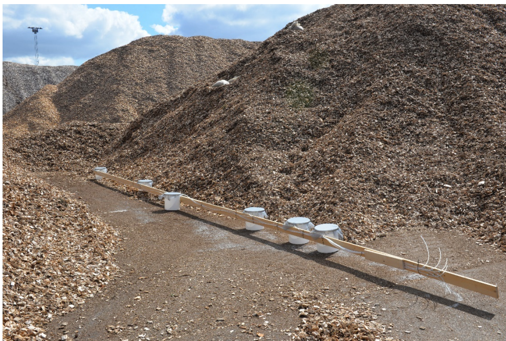
Billede 13: En række med 6 spande inden den graves ind i en flisstak. Her ses også de teflonslanger, som er monteret med henblik på udtagning af vandprøver fra spandene. (Foto: Simon Skov)
