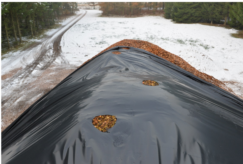
Billede 5: En flisstak med presenning (ikke hos Hadsund Fjernvarme). Der ses ventilationshuller i toppen af stakken og en blottet ende til bortkørsel. (Foto: Simon Skov)
