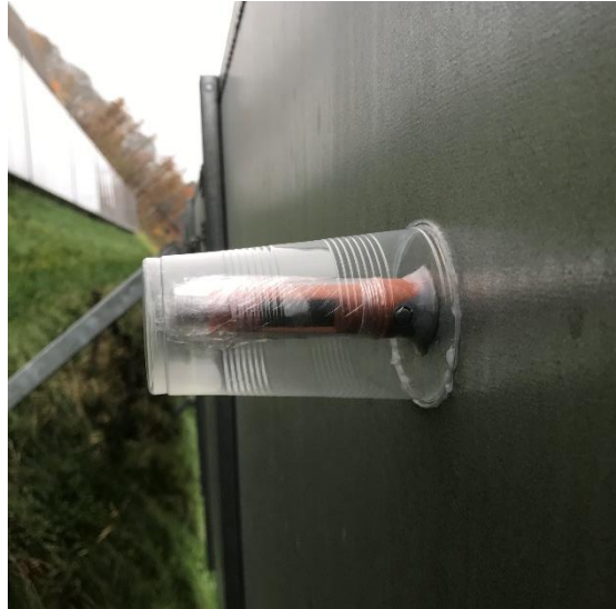
Figure 6. USB-datalogger monteret i isoleringsmaterialet for at måle temperatur og luftfugtighed.
