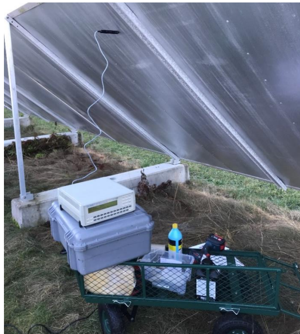
Figur 3. Isoleringsevne målt med nålesonde i en solfanger.
