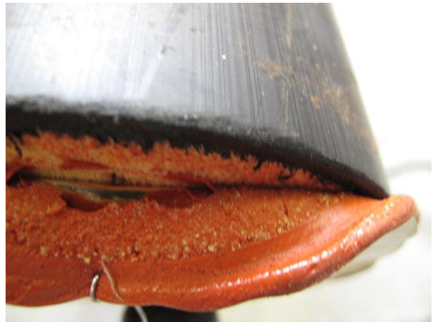
Billede 3a og 3b: Den hidtidige og til projektet anvendte forsegling direkte på snitfladen af kapperøret. Se også figur 3.
