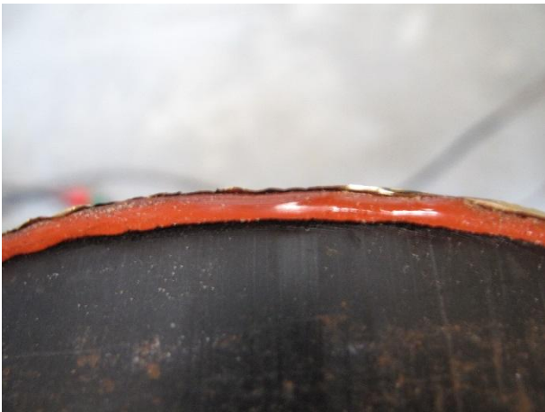
Billede 3a og 3b: Den hidtidige og til projektet anvendte forsegling direkte på snitfladen af kapperøret. Se også figur 3.
