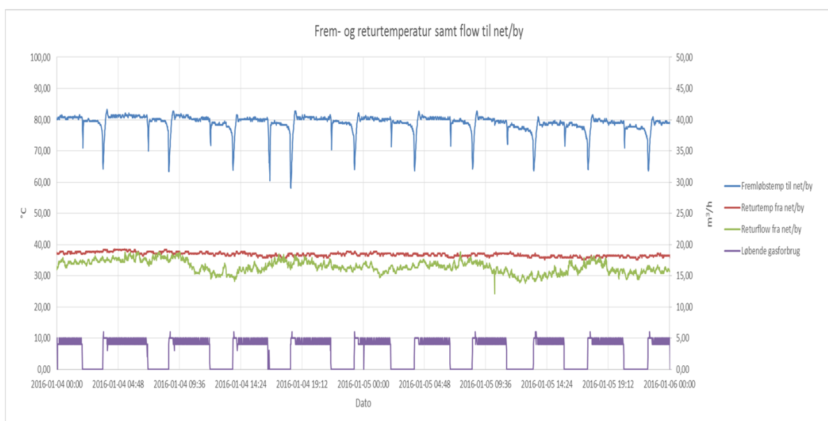
Figur 7: Fremløbs- og returtemperatur samt fjernvarme- og naturgasflow for 4. og 5. januar 2016 for Hvam – Gl. Hvam Kraftvarmeværk.
