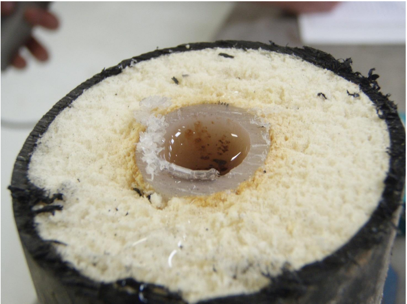
Figur 2: Medierørene blev afproppet i den ene ende og fyldt med vand svarende til rør i drift for at målingerne blev så realistiske som mulig
