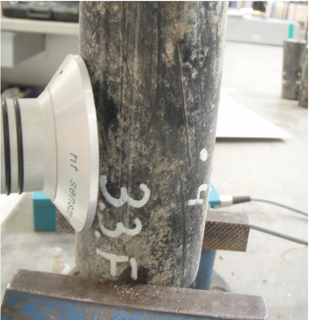
Figur 3: Måling af fugtindhold med mikrobølgesensor; rørets krumme overflade er en udfordring i forhold til sensorens anlægsflade
