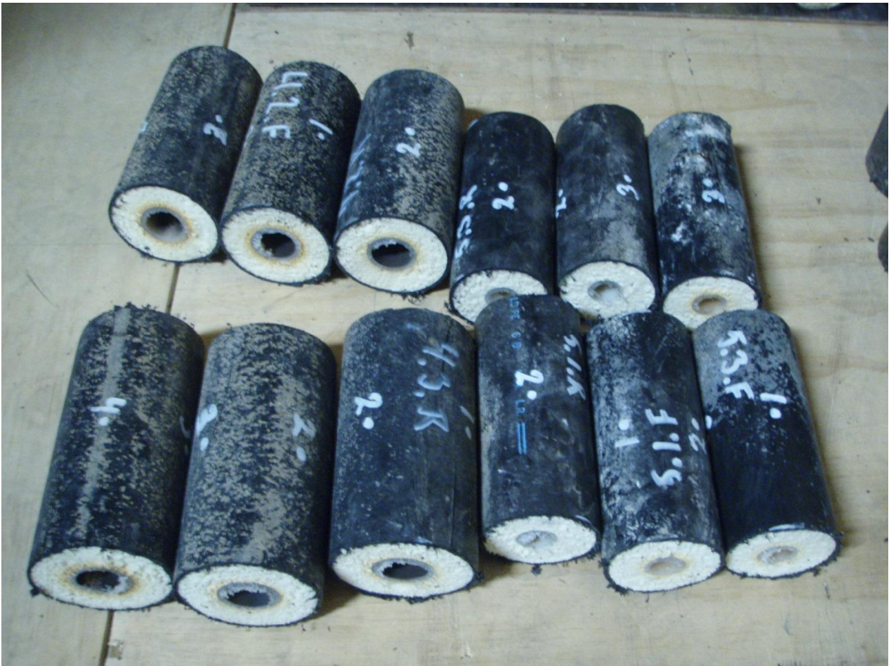
Figur 4: Udsavede rørstykker lagt til udtørring ved 70 °C indtil vægten var konstant
