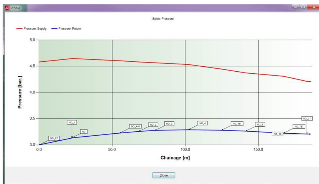
Figur 9: Trykprofil for spidslast på Hyrdebakken ved 55/30°C for stålør
