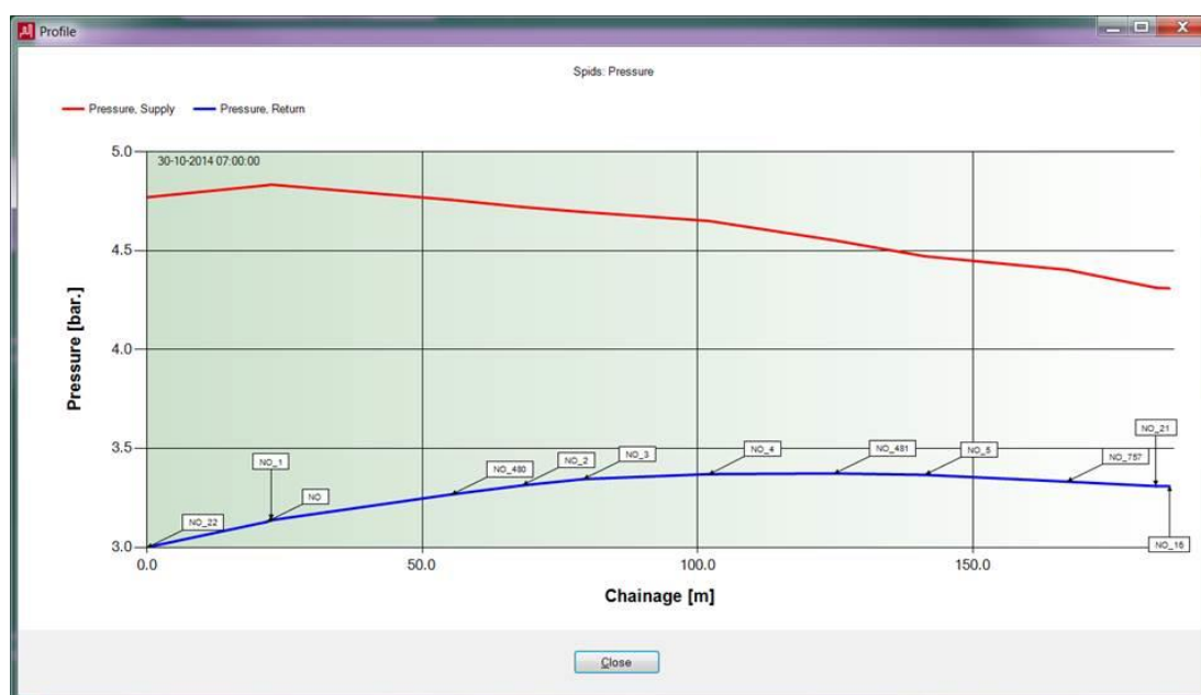
Figur 8: Trykprofil for spidslast på Hyrdebakken ved 55/30°C for plastrør
