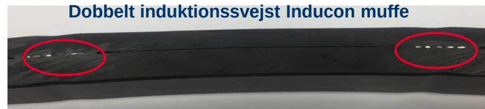
Stærkeste svejsemuffer ved DF test i 2013
