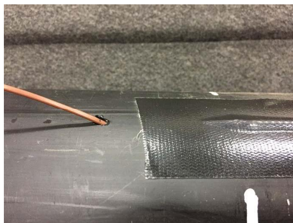
Billede 6: En thermocoupler anbringes på oversiden af medierøret. Under tapen ses til højre en tilsvarende anbragt på oversiden af kapperøret
