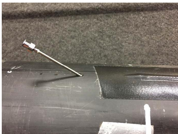
Billede 5: Gennem en kanyle injiceres varmeledende pasta ned til overfladen af medierøret.
